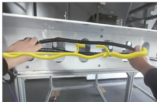
(b) 线束引导装配定位第一视角
